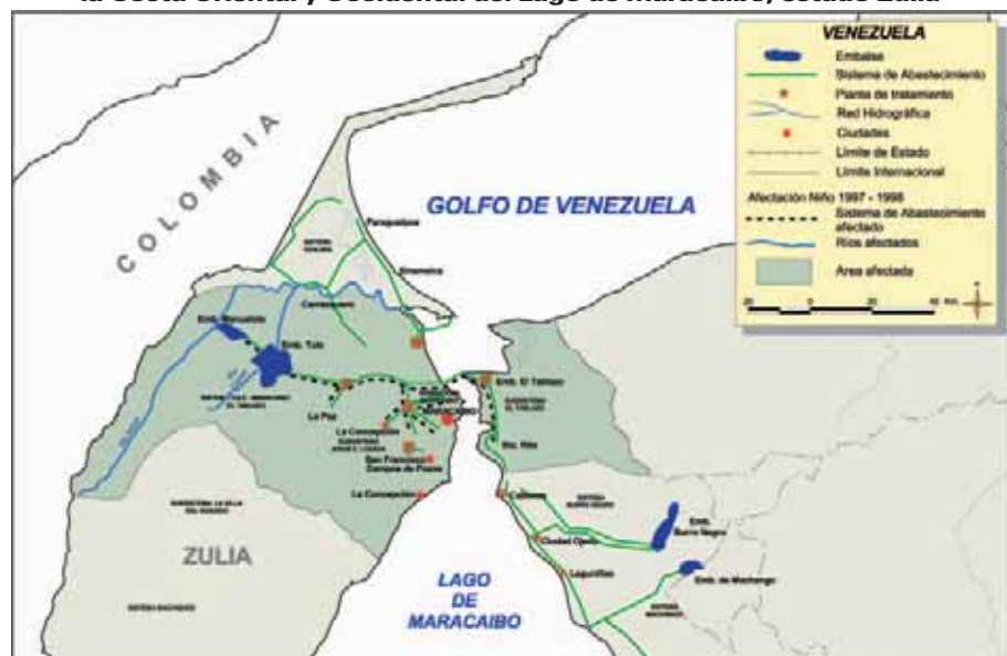
Figura V.1.3-3. Venezuela. Afectación sistemas de abastecimiento de agua en la Costa Oriental y Occidental del Lago de Maracaibo, estado Zulia
