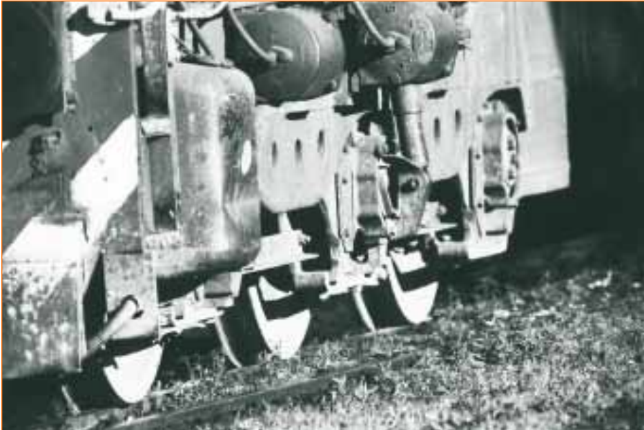
Ruedas de acero sobre rieles de acero ofrecen baja resistencia al rodado. La guía permite altas velocidades con seguridad.
