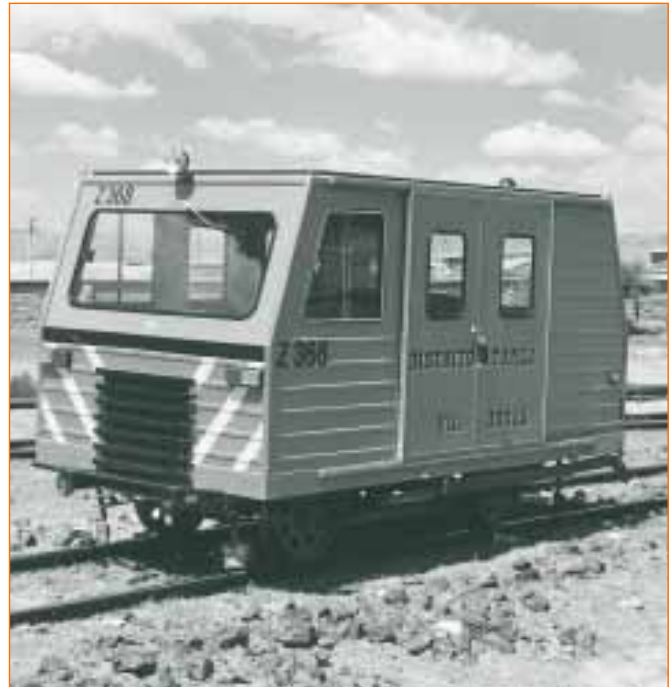
Autovía, vehículo de inspección en Tupiza, red Andina de Bolivia.
