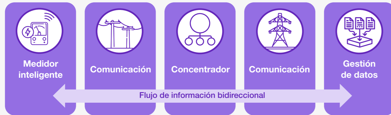
Esquema típico de AMI
