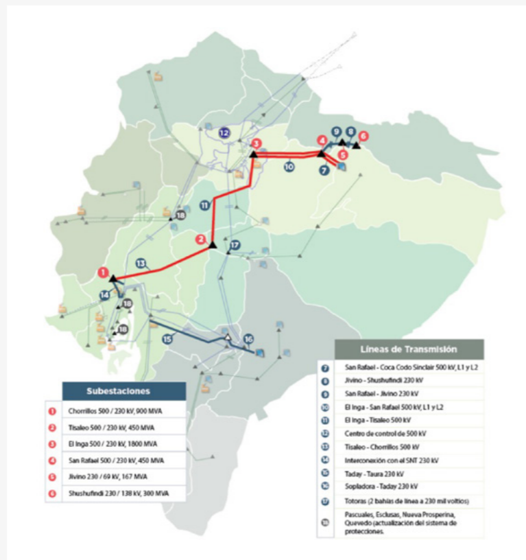
Sistema de transmisión de Ecuador
