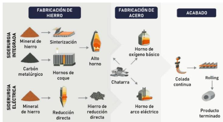
**Figura 11.** Rutas de proceso de producción de acero.
