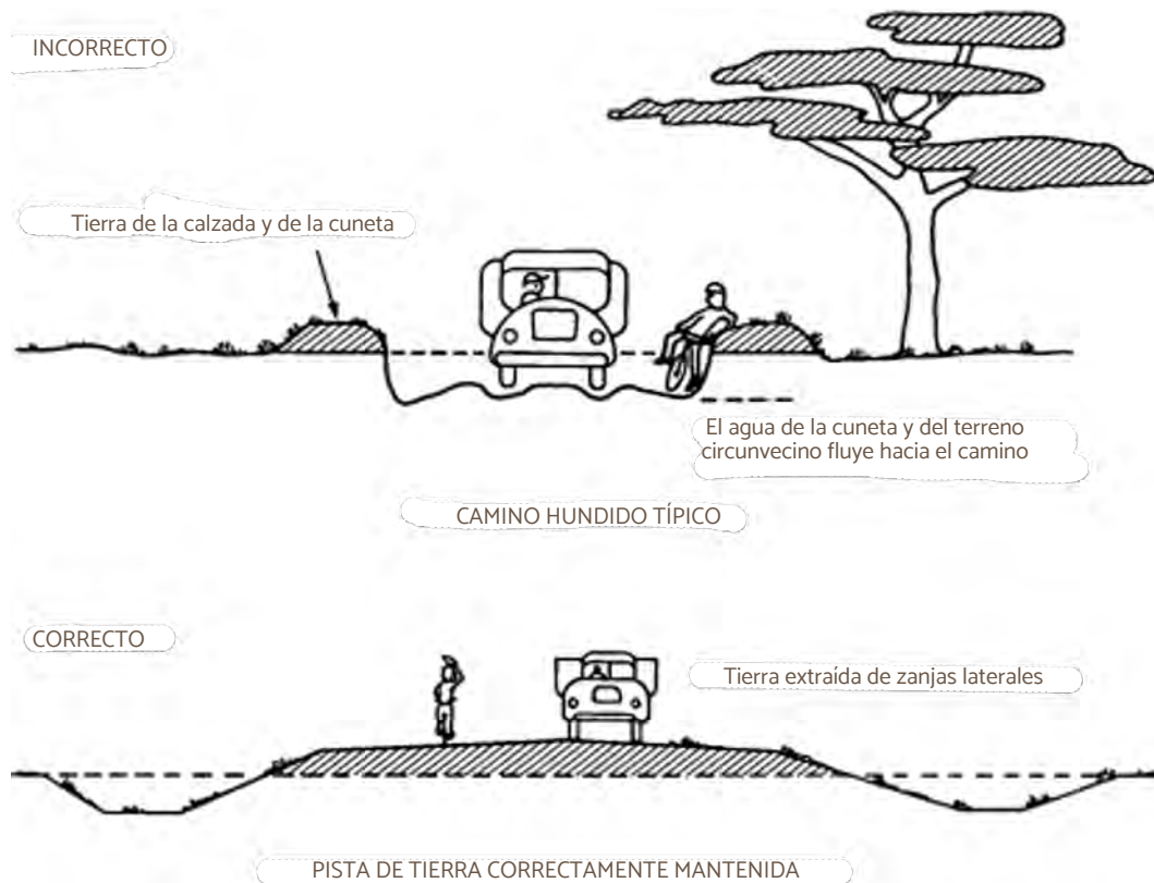
FIGURA 3.2. CAMINOS DE TIERRA MANTENIDOS INCORRECTA Y CORRECTAMENTE
