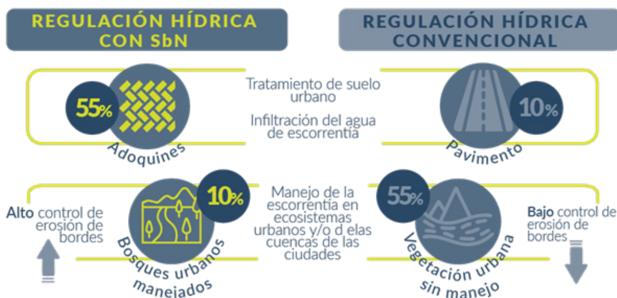
Figura 7. Ejemplos de SbN para el control de infiltración y escorrentía de agua en las ciudades.
